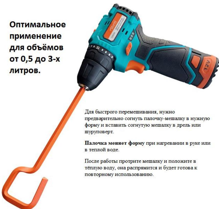
Для быстрого перемешивания, нужно предварительно согнуть палочку-мешалку в нужную форму и вставить согнутую мешалку в дрель или шуруповёрт.
